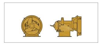
●撹拌方向が簡単に設定でき、泥水撹拌に最適です。
